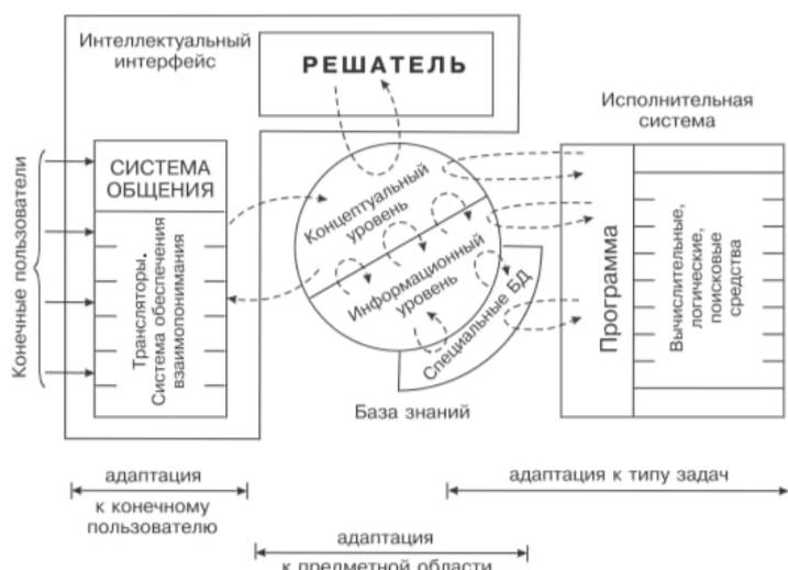
Рисунок 1 – Функциональная структура системы ИИ
